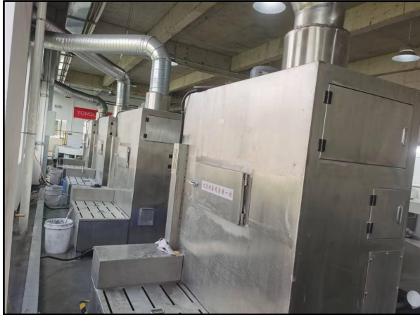
砂带打磨抛光机配套的湿式除尘装置
