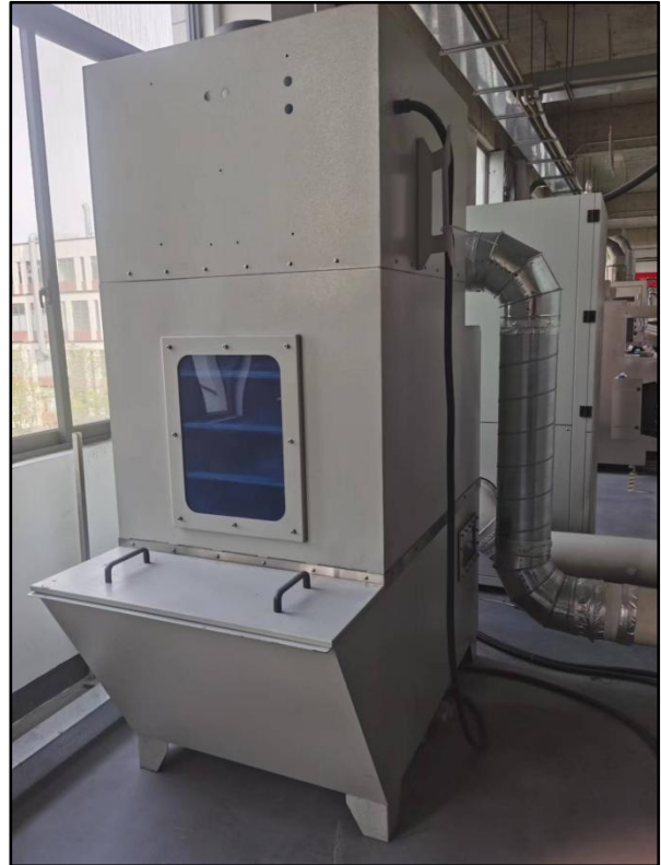
拉丝机配套的湿式除尘装置
